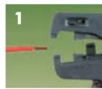
1 Decape o fio aproximadamente 12mm, conforme o gabarito da peça (figura 2).
